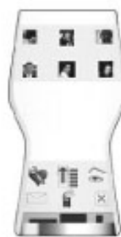
El modo de proximidad es un guardapantallos que muestra las imágenes de las personas en un radio de 1.5 a 2 metros de un vaso. Cada vaso contiene un chip RFID que permite esta función.
