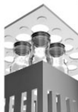
Una batería por inducción se localiza en la base de los vasos y se cargan mientras se encuentran secando boca abajo en el escurridor. Una tapa inductora sobre el escurridor recarga la batería en el vaso.
